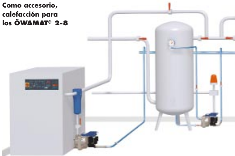
Estación de aire comprimido con los purgadores electrónicos BEKOMAT® y los separadores de aceite/agua ÖWAMAT®
