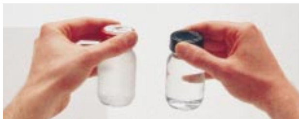
Cambio de los filtros. La comparación con la turbiedad de referencia indica el cambio.
