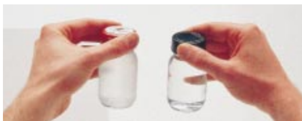
Filterwechsel: Der Referenz-Trübungstest zeigt, wann er nötig ist.
